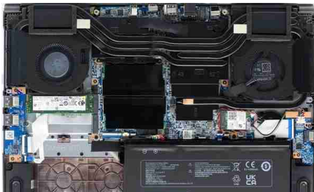
▲该机的内部图，双风扇五热管（一根是隐藏式的），双内存插槽，双SSD插槽。
