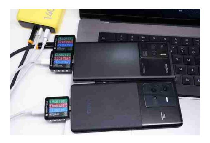
三个接口同时输出,测得USB-A、USB-C1/2口的功率分别为23.89W、36.54W、63.12W。
