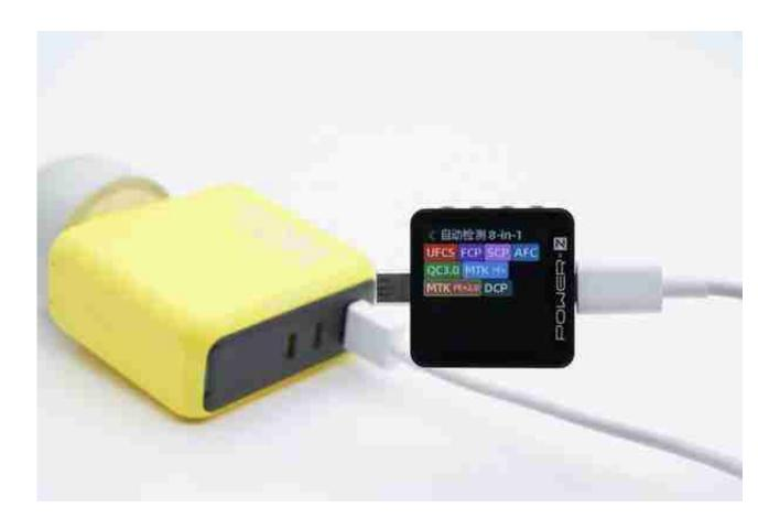
使用 POWER-Z KM003C 测试仪测试 USB-A 端口充电协议,实测支持UFCS、FCP、SCP、AFC、QC3.0、MTK、DCP 等充电协议。
