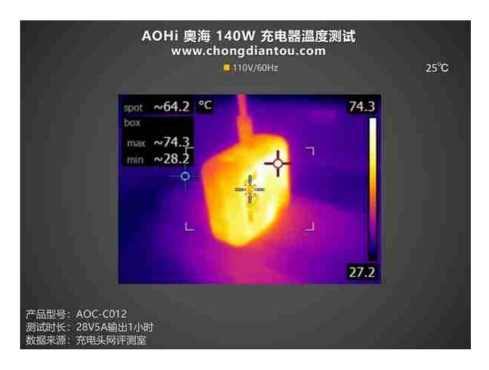
一小时后,使用热成像仪拍摄的充电器表面最高温度为74.3℃
