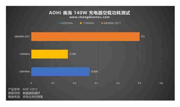
经过功率计测试,充电器在220V 50Hz 电压下的空载功耗为0.269W,换算下来一年损耗的电能约为2.36KW·h,若市电价为0.6元/KW·h,则充电器一年的电费约为1.41元左右。
