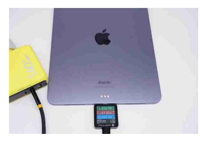
连接 iPad Air5 用 POWER-Z KM003C 测试仪读取功率为 14.82V 2.26A 33.50W。
