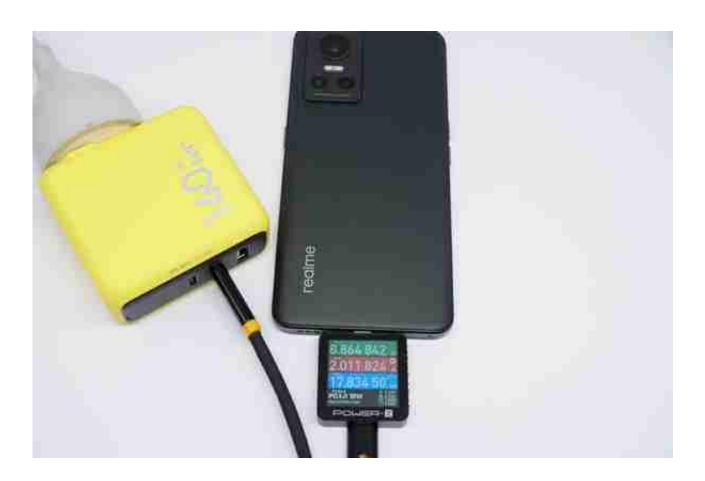
将 realme GT Neo3 充电口插入USB-C 端口,使用 POWER-Z KM003C 测试仪读取功率为 8.86V 2.01A 17.83W。
