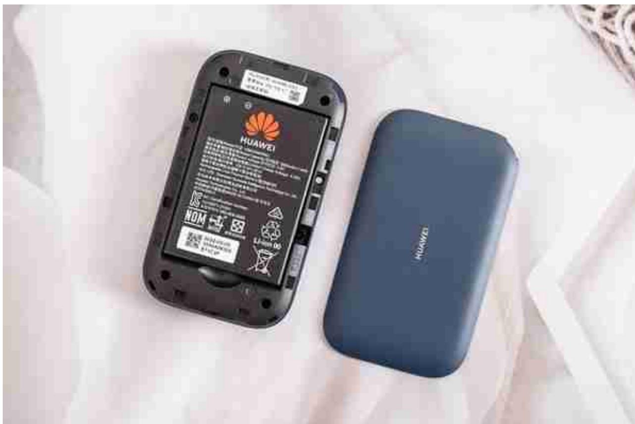
背面的话，后盖是可拆卸设计的，只需在下方的拆卸口位置，轻轻扣一下即可取出后盖。拆开后，可以看到电池，内置了3000mAh电池容量，在满电状态下，可工作时长高达12小时，足够应付日常工作联网需求，多天使用不充电也够用了，续航还是很给力的。
