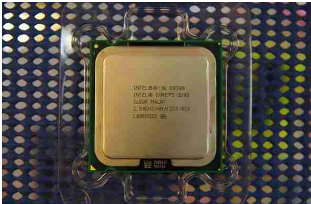
而且，跟双核E8400比较，虽然Intel酷睿2四核Q8300CPU在主频和二级缓存上稍低，但由于是四核cpu，因此整体性能更好。此外，作为目前酷睿4核心的入门型号，拥有酷睿2家族所有特点，包括SSE4.1支持、虚拟化硬件支持等。
