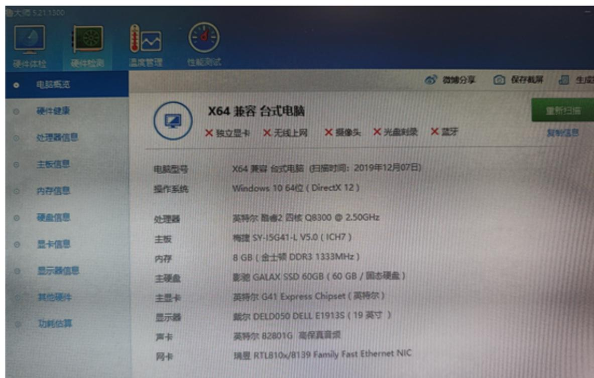
首先，测试的这颗Q8300CPU封装地是马来西亚，主频2.5GHz，外频333MHz，倍频7.5倍，4线程 4核心，前端总线 1333MHz，热设计功耗95W，二级缓存4MB，64位处理器。并且，采用了最新的R0步进。
